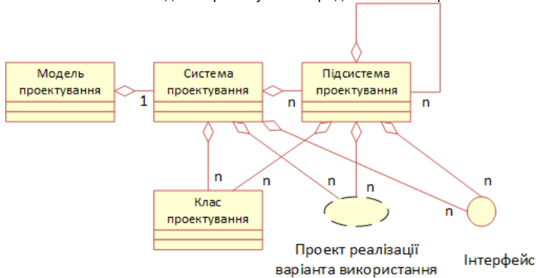
Рисунок 3.3 – Узагальнена модель проектування
